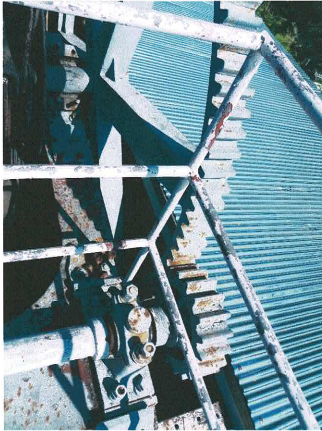
รูปที่ ๑๖ แสดงเฟืองส่งกำลังไปขับเฟืองใหญ่เพื่อหมุนเพลาราวบั้งก็
