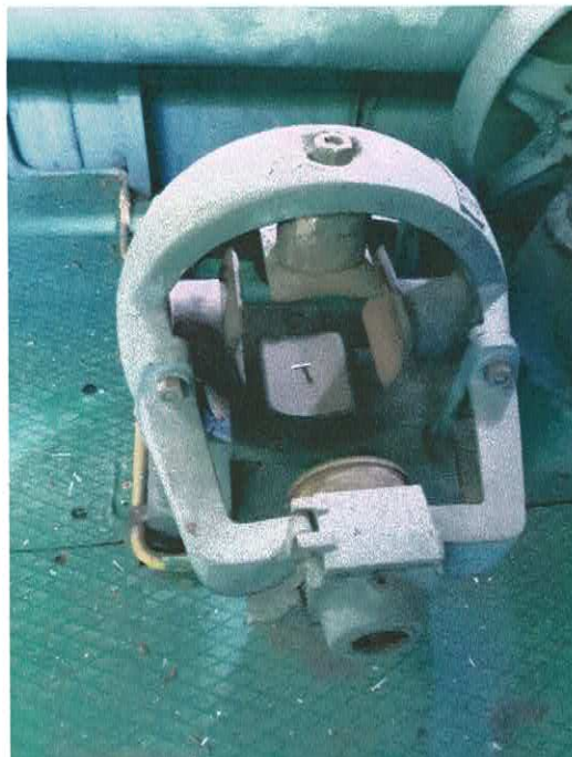
รูปที่ ๒๑ ชุดไดนาโมใช้สำหรับขับเคลื่อนกระแสน้ำไฟฟ้าใช้ในเรือชุด
