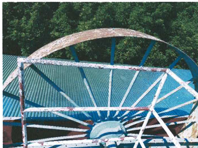
รูปที่ ๑๕ มุ่เลย์ด้านบนรับกำลังจากสายพานขับ เพื่อส่งกำลัง ไปยังเฟืองส่งกำลัง (รูปที่ ๑๖)
