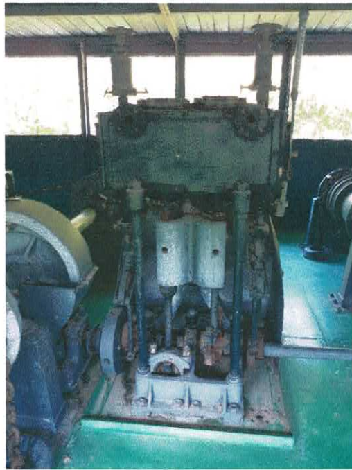
รูปที่ ๑๐ เครื่องยนต์สำหรับขับเคลื่อนก้าน
