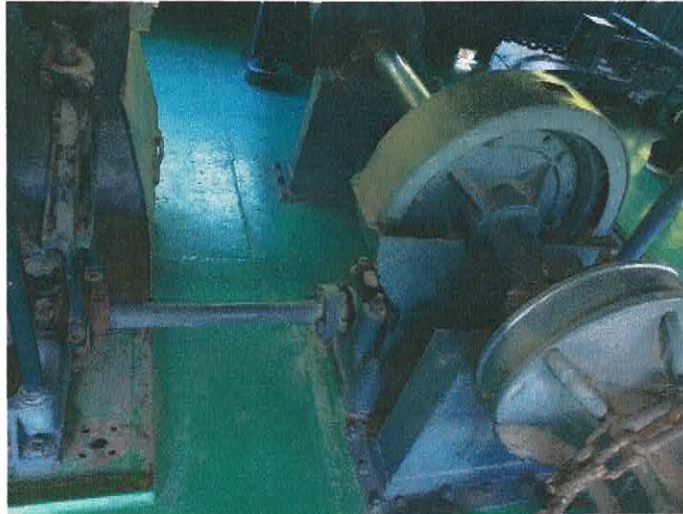
รูปที่ ๑๑ ชุดขับเฟืองตัวหนอน (Worm Gear) และเฟืองตรง (Spur Gear)
