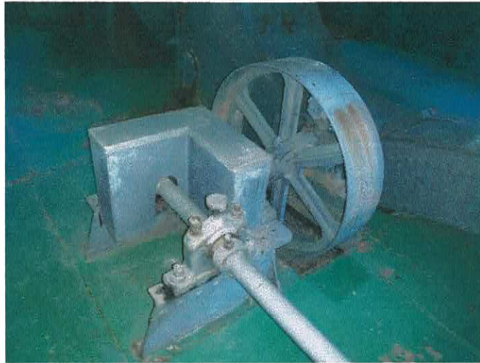
รูปที่ ๑๔ มุ่เลย์ที่รับกำลังจากเพลลาเครื่องยนต์ใต้ท้องเรือ
