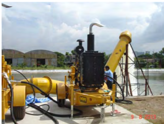
เครื่องสูบน้ำขับเคลื่อนด้วยระบบไฮดรอลิก ขนาด 1.0 \text{ m}^3/\text{sec.} (Ø ๒๔ นิ้ว)
