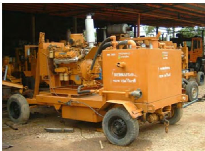
เครื่องสูบน้ำขับเคลื่อนด้วยระบบไฮดรอลิก ขนาด 1.5 \text{ m}^3/\text{sec.} (Ø ๒๘ นิ้ว)
